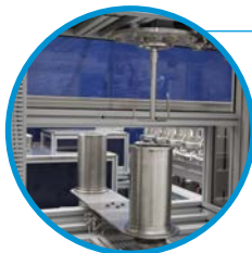
DWS 溶解单元 溶解微量染 料并分配到 外部小染缸
