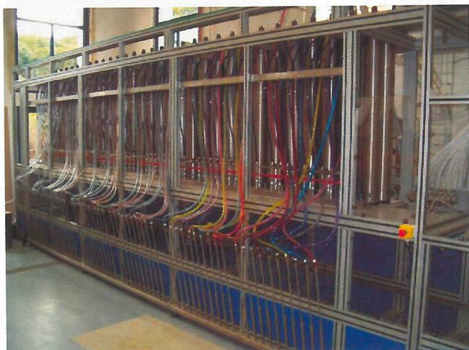
Bild 1 Dosieranlage Typ LS 60 für Farbstoffe
