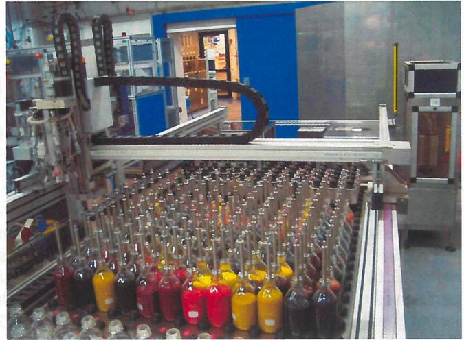
**Bild 4** Dosieranlage Farbstofflösungen WSD 288
