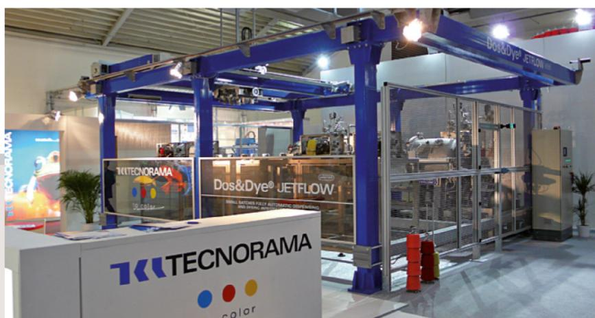
**Il sistema completamente automatico Dos&Dye per la tintura jet per piccoli lotti da 2 a 30 kg, di tessuti ortogonali o di maglieria**
