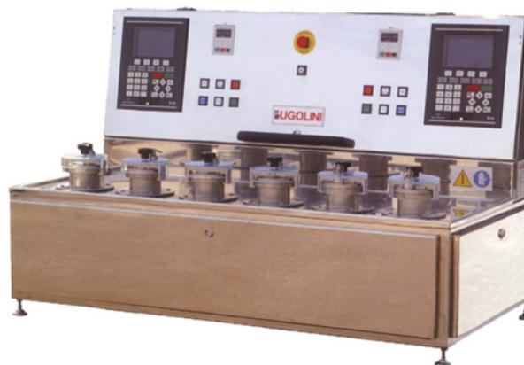
**L'apparecchio da laboratorio a pressione Magnetodye della Ugolini di Schio (VI)**
