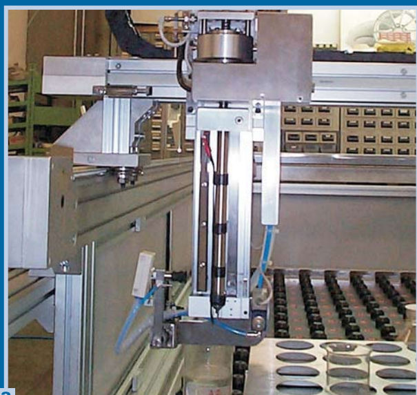
3 Particolare della singola pipetta Detail Pipett
